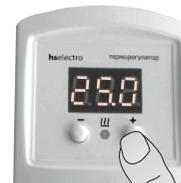
После последнего нажатия одной из кнопок микроконтроллер отсчитывает 5 секунд и если нет команд, запоминает выставленные значения и переводит устройство в обычный режим.
